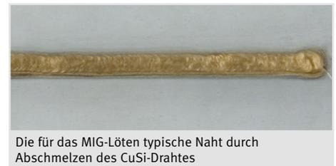
Die für das MIG-Löten typische Naht durch Abschmelzen des CuSi-Drahtes
