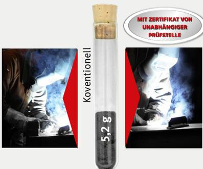
Schweißrauch, der beim Verschweißen von 1kg SG-Draht entsteht
