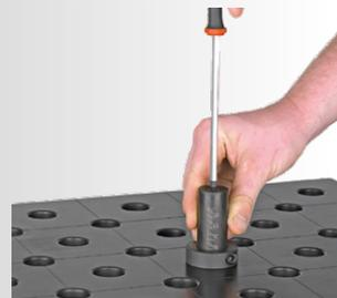
› Klemmung eines Vario Spannbolzen 28 S mit Inbusschlüssel
