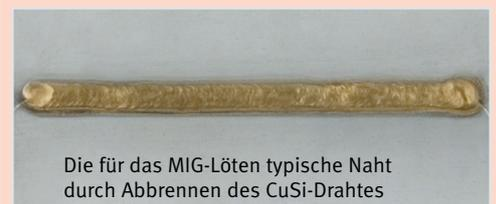
Die für das MIG-Löten typische Naht durch Abbrennen des CuSi-Drahtes
