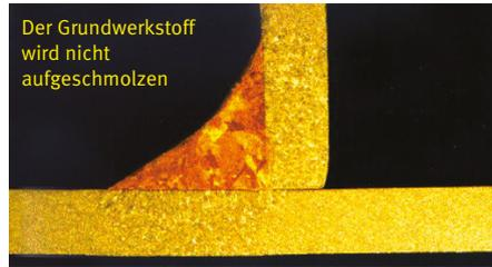
Der Grundwerkstoff wird nicht aufgeschmolzen
