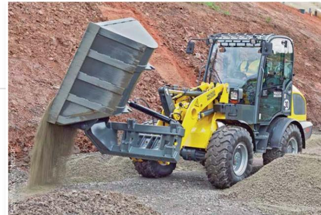
Verfüllen mit Seitenkippschaufel: gute Sicht aus der Kabine und hohe Standsicherheit.
